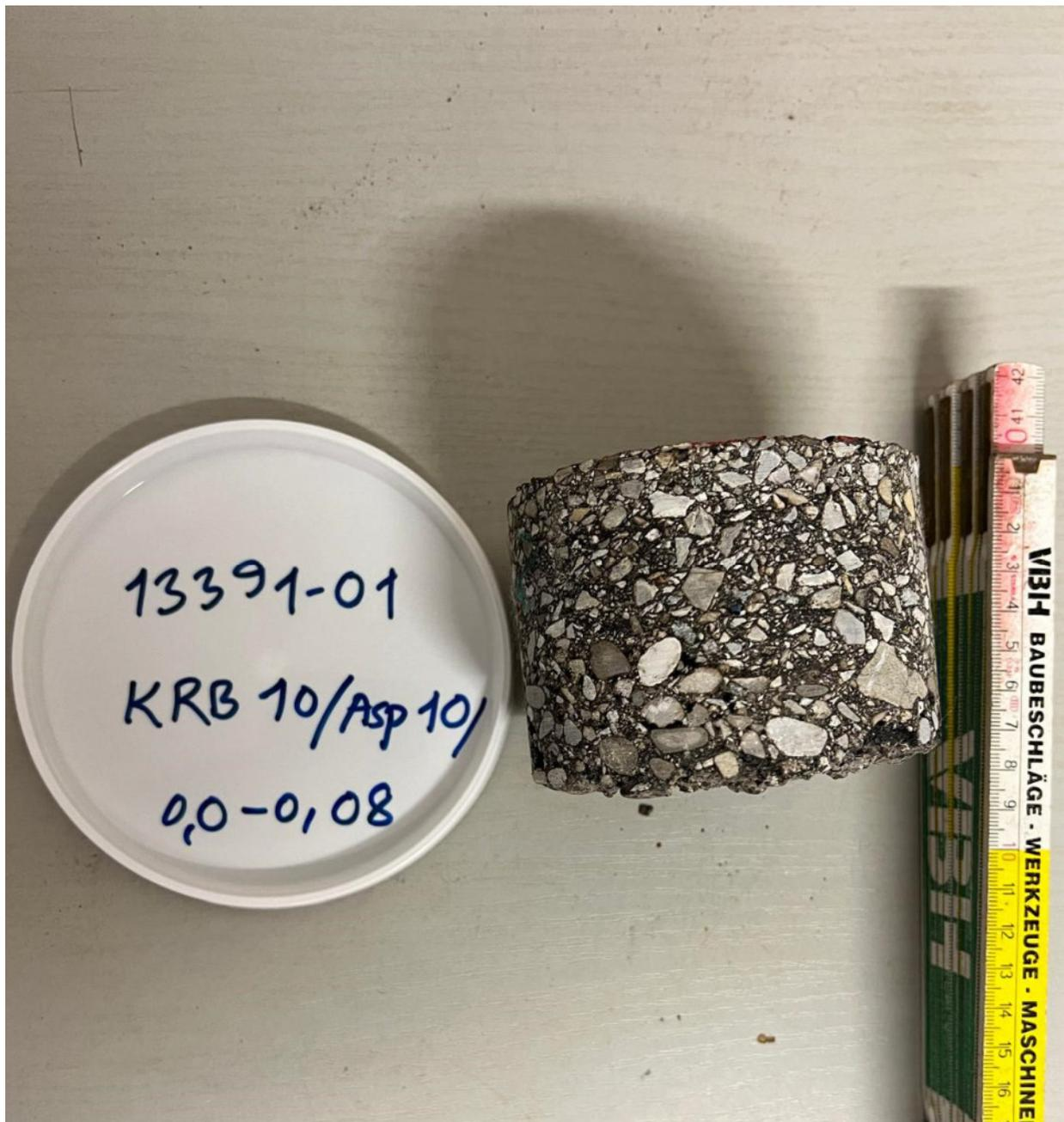
**Abb. 1, 14.08.2024: Fahrbahnbefestigung bei KRB 10
