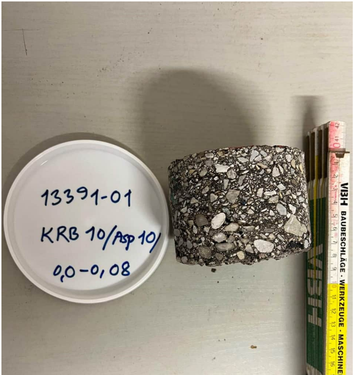
Abb. 1, 14.08.2024: Fahrbahnbefestigung bei KRB 10 Stärke Asphalt 8 cm
