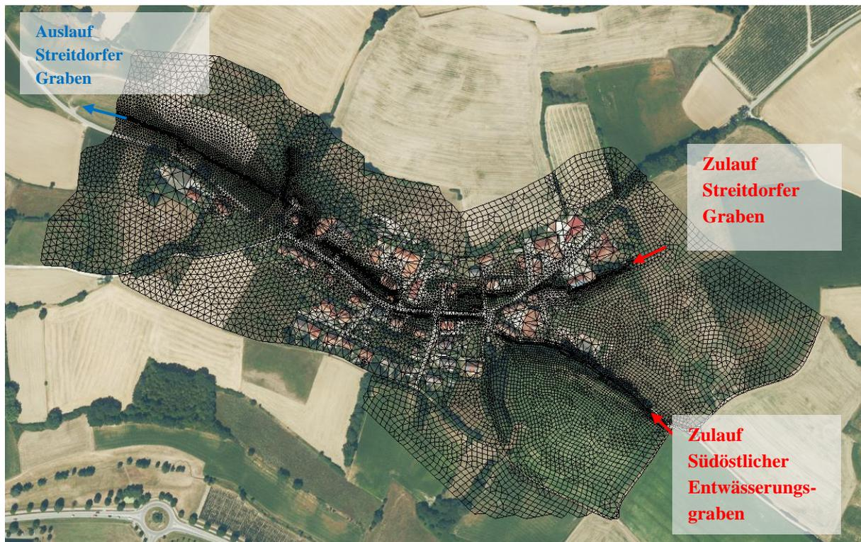
Abbildung 3: Netz des Untersuchungsgebietes mit Zu- und Abläufen
