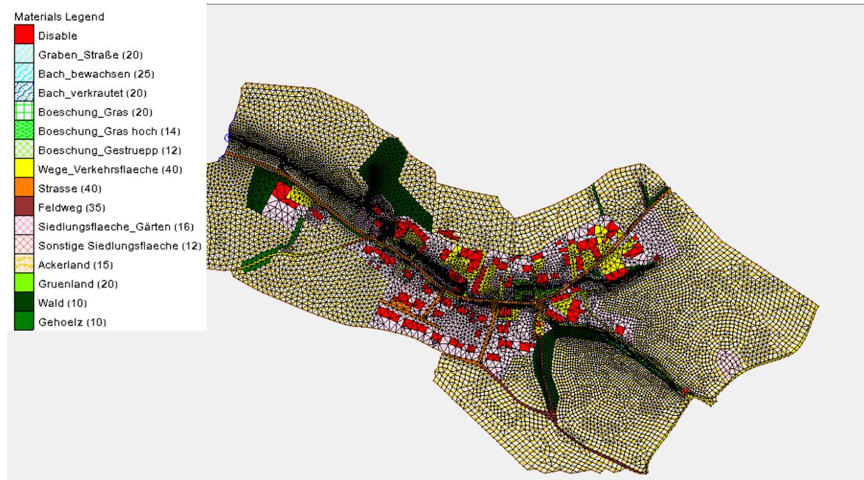
Abbildung 5: Hydraulische Rauheiten Übersicht
