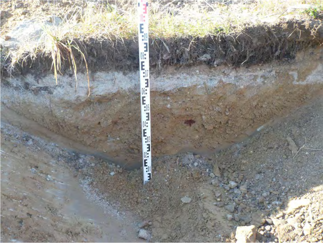
Abb 5: Schurf PS 2 mit enthaltener Lage aus Mineralbeton.
