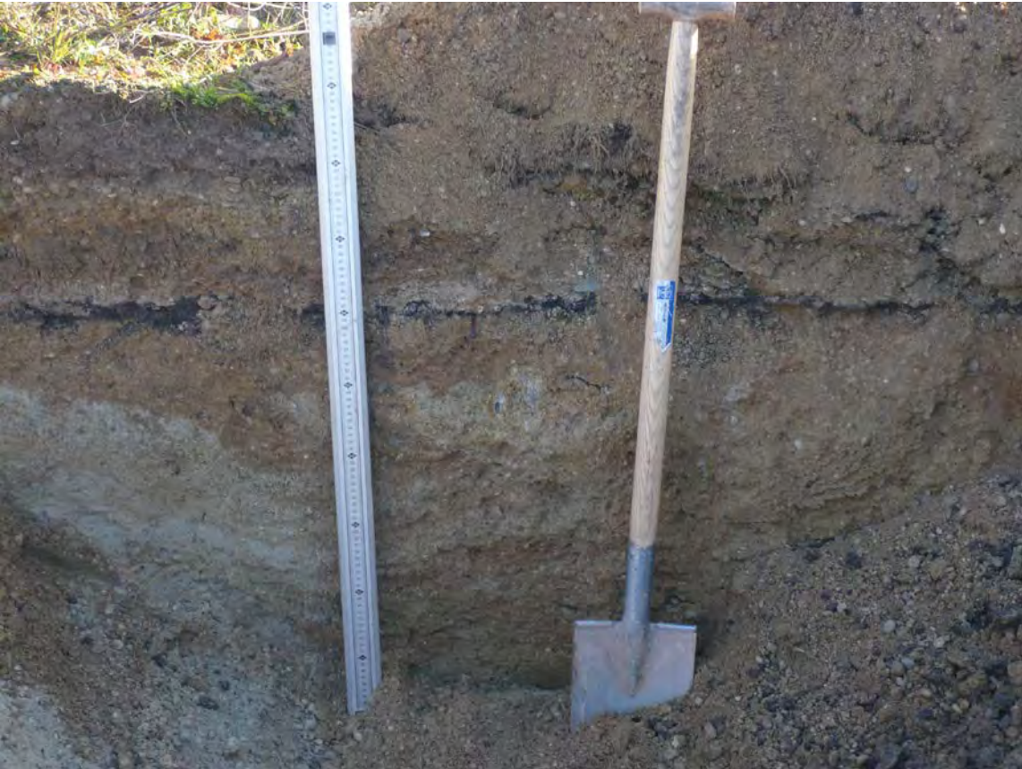
Abb 4: Schurf PS 1 mit enthaltener Asphaltlage.
