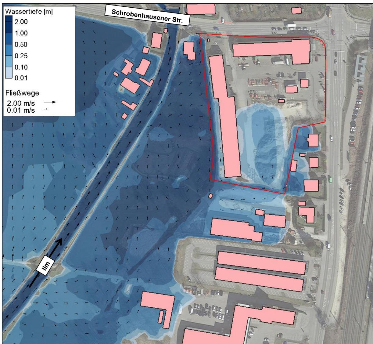
Abbildung 4-1: Wassertiefen und Fließrichtungen im Überschwemmungsgebiet HQ<sub>100</sub> – Istzustand (Hintergrund: © Google Satellite)
