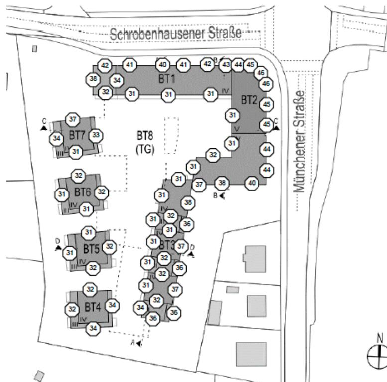
Abbildung 13: erforderliche gesamt bewerteten Bau-Schalldämm-Maße ( $R'_{w,ges}$ ) von schutzbedürftigen Aufenthaltsräumen nach DIN 4109
